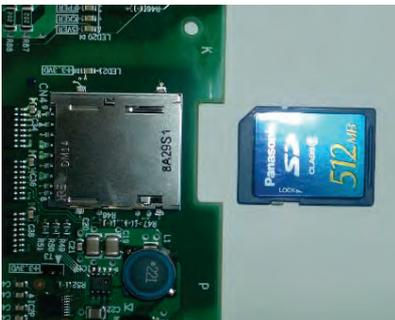
专用的数据存储卡对已发生事件记录, 通过个人电脑可对存储卡上的波形数据进行传递和判读, 实现对设备状态精确分析。便于工程师分析、判断故障类型, 加快维修响应速度。
