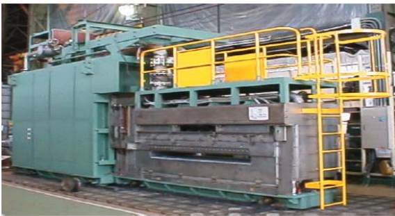
Calentador tipo Solenoide - Nivel de potencia: up to 9,000 KW - - Frecuencia de Inductor: 1,400 Hz - Aumento de temperatura : 40°C
