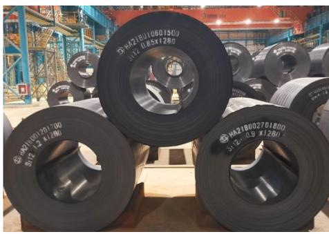
1.2 毫米、0.9 毫米、0.85 毫米成品卷
