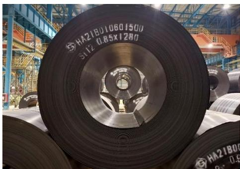
厚 0.85 毫米 x 宽 1280 毫米成品卷
