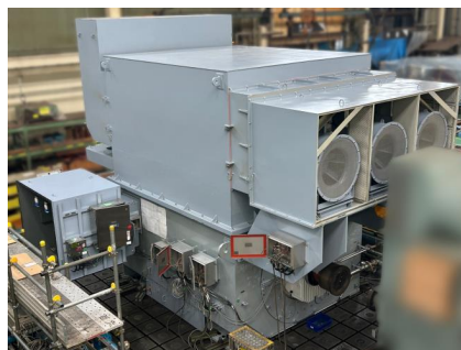
在 TMEIC 测试中心的低启动电流、空-空冷却的 4 极同步电机
