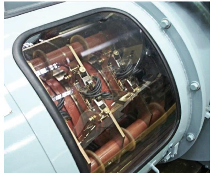
*Figura 3. Anillos deslizantes típicos en un motor*
