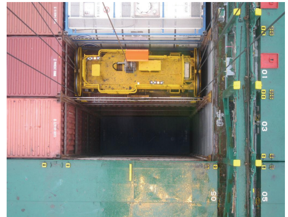
Figura 1 Spreader en celda (vista desde cabina)
