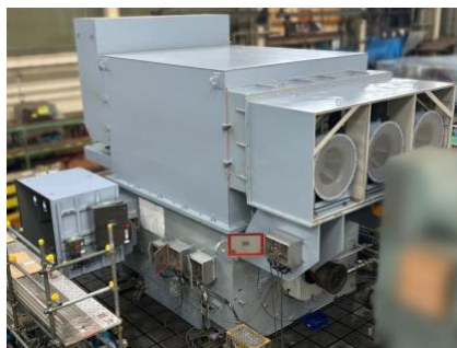
在 TMEiC 测试中心的低启动电流、空-空冷却的 4 极同步电机
